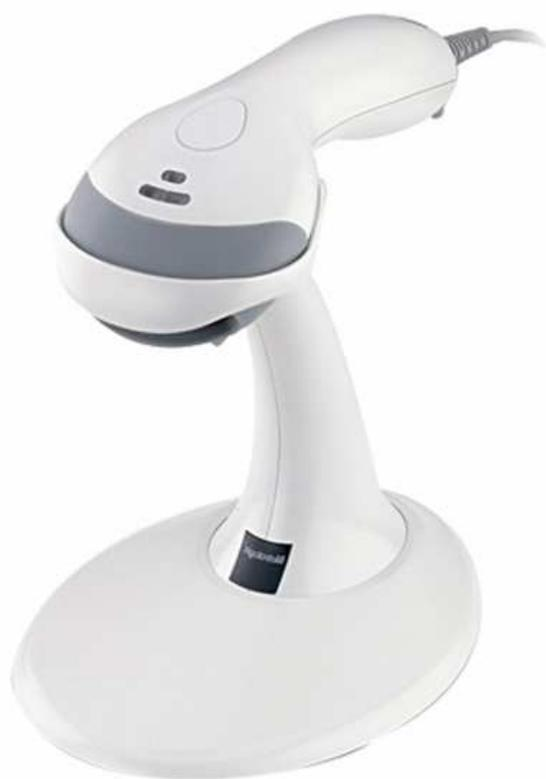
Лазерный, ручной сканер с одной плоскостью сканирования, является усовершенствованным аналогом сканера MS951. Входящий в комплект поставки стенд позволяет использовать сканер в качестве стационарного устройства. Имеет встроенный инфракрасный сенсор, обеспечивающий включение сканера при появлении объекта в области считывания.
